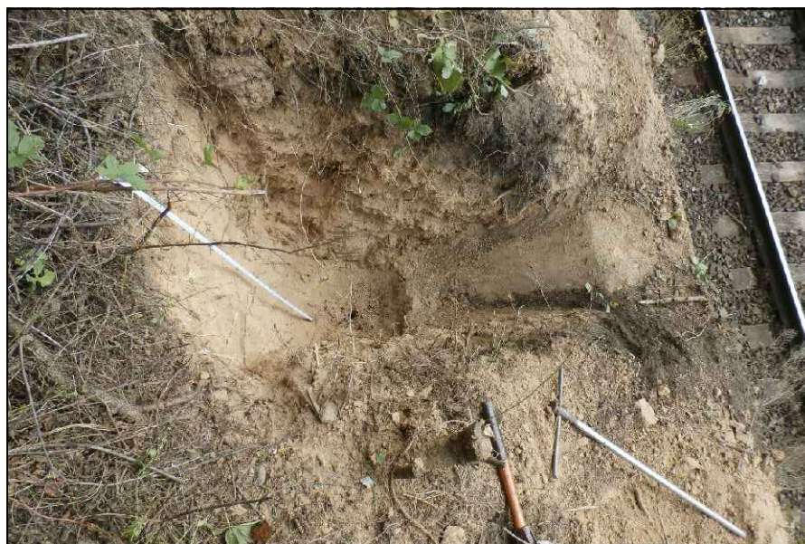
Obr. č.1: Kopaná sonda pro ověření tvaru zárubní zdi.
